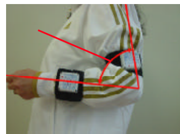
腕の屈曲動作時の動作角度計測結果 オプションの動作角度計測ソフトウェア使用
