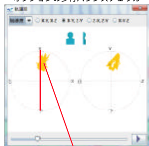
歩行時の体幹部分の加速度計測結果 (リサージュ図形表示) オプションの歩行バランスチェッカー使用
