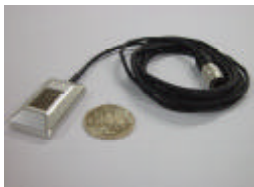
3軸加速度センサ MA3-**-AD-RDB
