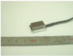
3軸加速度センサ (小型ヘッド)
